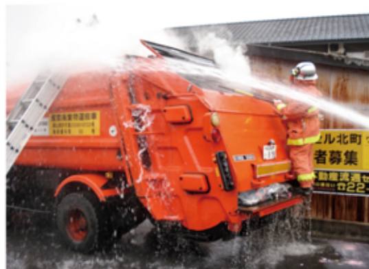
スプレー缶が原因で発生した収集車両の火災の消火作業
